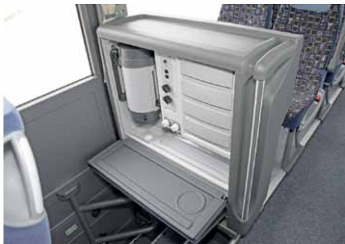
Links: Starker Motor mit 300 Kilowatt Leistung. Rechts: Die Bordküche des Typs QuickService MultiPlus von TM Technischer Gerätebau.
