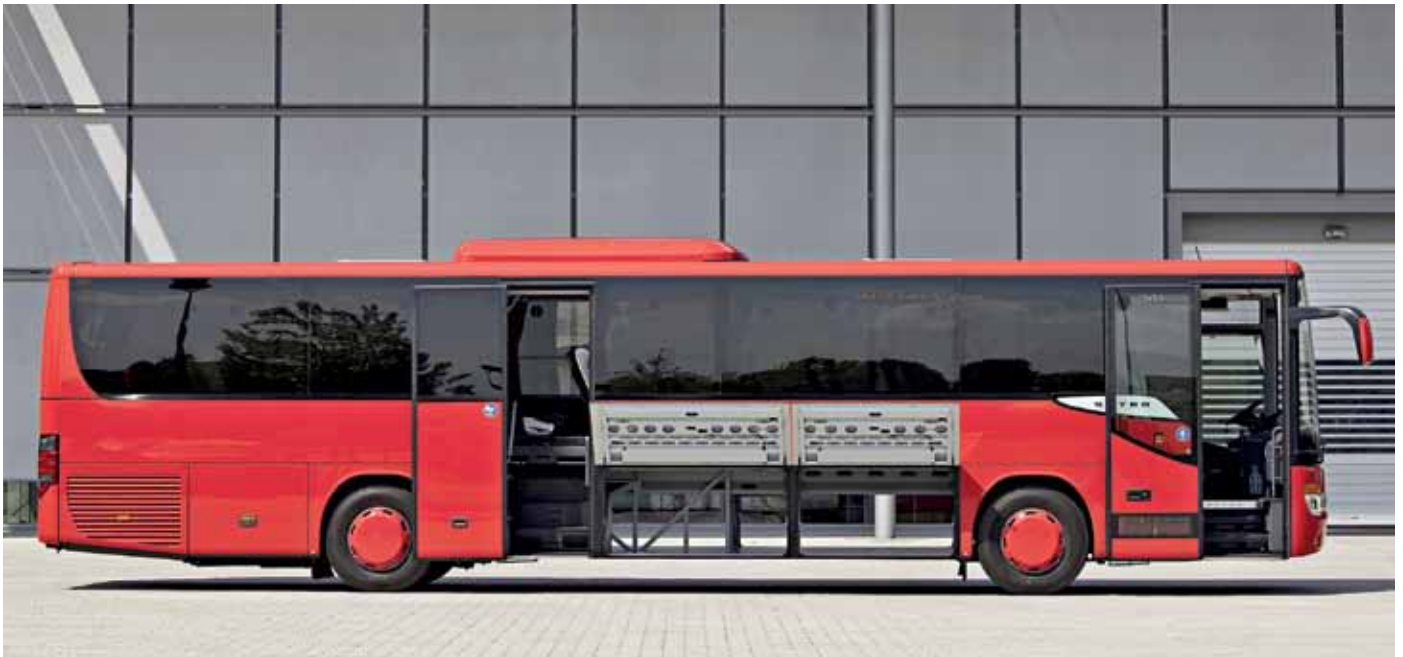
Eine der Stärken der Baureihe H ist der große Kofferraum. Die beiden einzelnen Schwenkschiebetüren gehören zur Grundausstattung.
