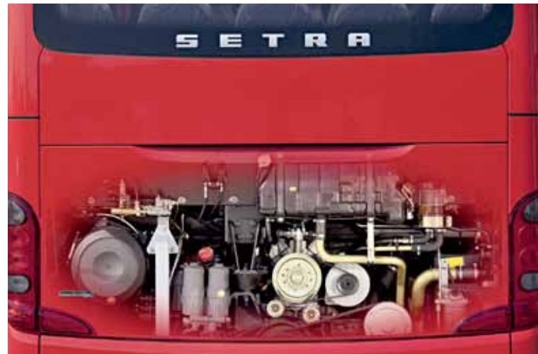
Der Sechszylindermotor mit 220, 260 oder 300 Kilowatt Leistung.
