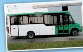
City VI / VII 7,6 bis 8,5 m durchgehend Niederflur Front oder Heckmotor bis 40 Personen Diesel oder CNG Basis Daily oder Sprinter
